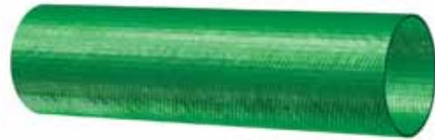
**289GG****Удаление воды из шахт - PVC - гладкий****Внутренний слой:** Зеленый PVC**Усиление:** Высокопрочная текстильная оплетка**Наружный слой:** Зеленый PVC - стойкий к истиранию, порезам и воздействию ультрафиолета**Применение:** Слив воды в тяжелых условиях
